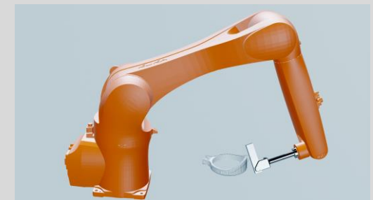
Simulation der Ausführung eines Roboterpfades entlang der vorab berechneten Strömungslinien
